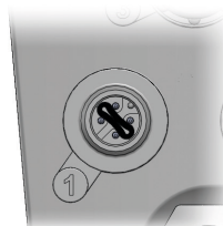
Ilustracja 21: Gumka przewodząca w gnieździe przyłączeniowym 1
