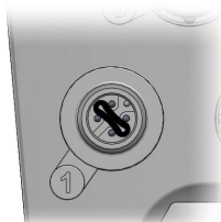
Ilustracja 18: Gumka przewodząca w gnieździe przyłączeniowym 1
