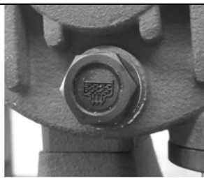
Korek spustowy oleju (poz.121)
