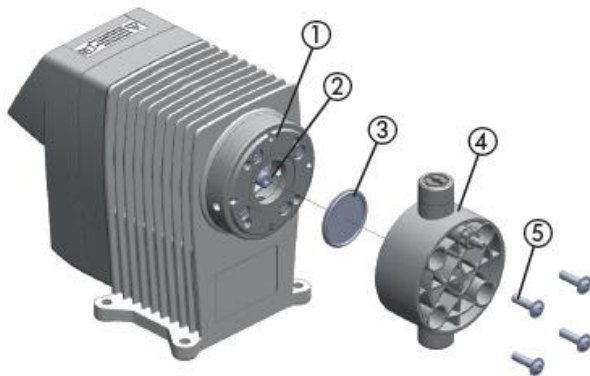
Rys. 65 Widok rozłożonych na części: membrany i głowicy dozującej
