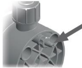
Rys. 17: Odpowietrznik głowicy dozującej z przyłączem węża
