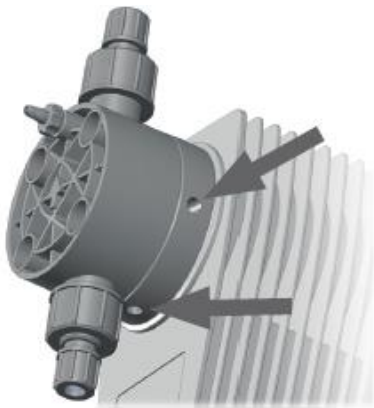
Rys. 16: Otwory do odprowadzania wycieku
