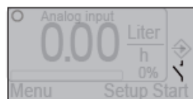
Rys. 64: Ekran startowy trybu Wejście analogowe z ikoną dla rozwartego styku
