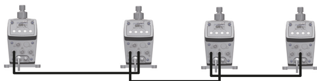
Rys. 19: Synchronizacja kilku pomp dozujących poprzez potwierdzenie skoku i sterowanie impulsowe
