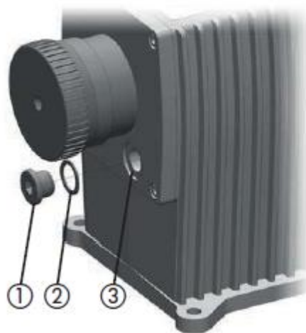
Rys. 12-1: Wypuszczanie oleju z pompy dozującej
