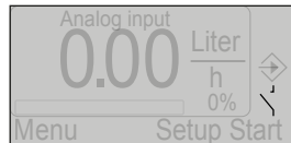
Ilustracja 49: Ekran startowy wejścia impulsowego z ikoną dla styku otwartego
