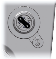
Ilustracja 22: Gumka przewodząca w gnieździe przyłączeniowym 3
